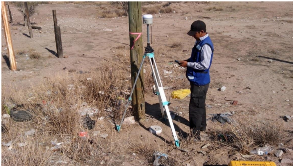
Figura 7: Toma de datos con GPS S10 de las mojoneras coladas.
